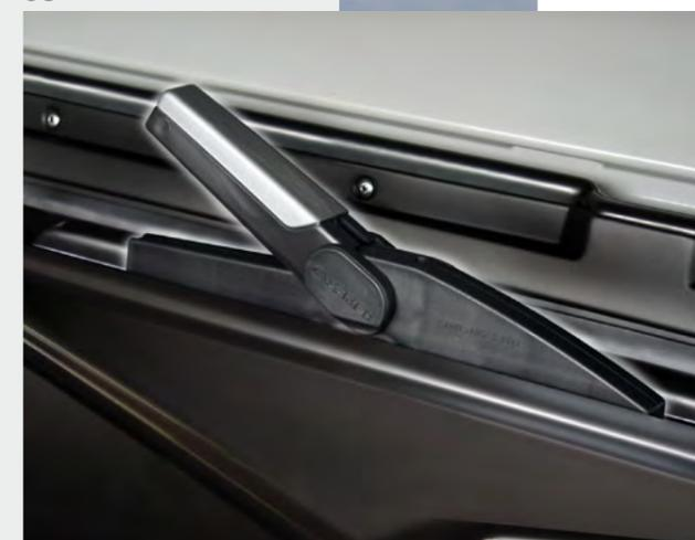
03 Die **Schnell-Spann-Befestigung** ermöglicht Ihnen ein einfaches und unkompliziertes Montieren der Dachbox auf Ihrem Fahrzeug innerhalb weniger Minuten. Durch Pumpbewegungen der Schnell-Spanner fixiert sich die Box auf dem Träger.
