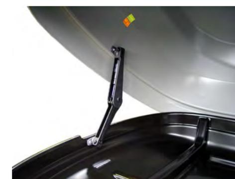
06 Kinderleichtes Öffnen und Schließen der Dachbox dank der vorn und hinten verbauten **Gasdruckfedern**. Öffnen Sie Ihre Dachbox mit geringem Kraftaufwand.
